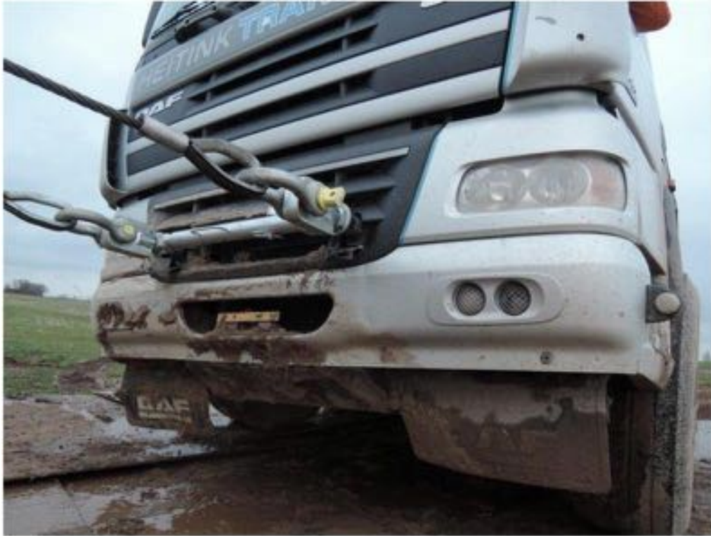
Hisser avec des câbles et des œillets de treuil
