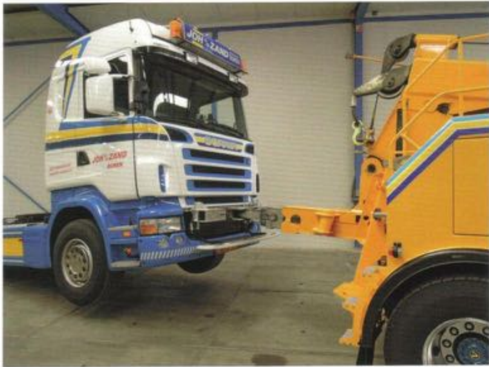
Soulever et remorquer avec une dépanneuse
