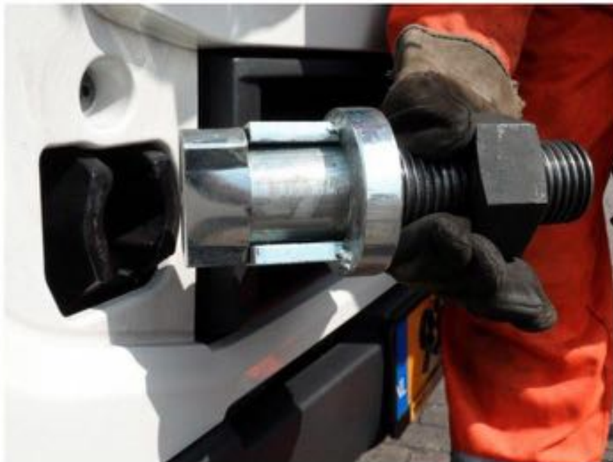
Placement de la tige de traction avec came
