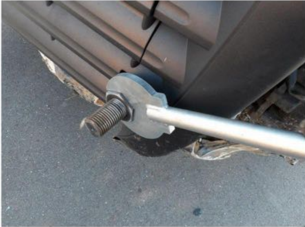
Fixation d'écrou de tige de traction
