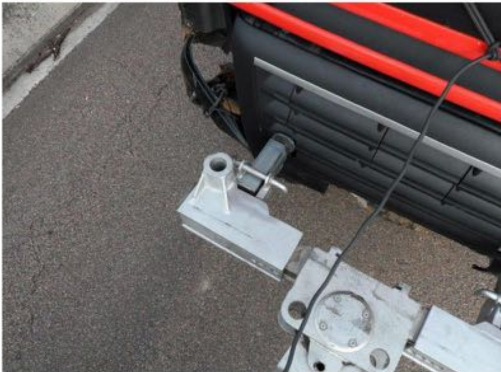
Crochet de traction attelé au support de levage et placement de broche à verrouillage
